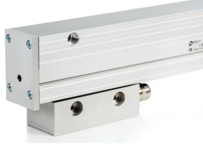
Фотоэлектрический прецизионный преобразователь линейных перемещений закрытого типа серии L35 предназначен для преобразования линейных перемещений рабочих органов станков в электрические сигналы, содержащие информацию о величине и направлении этих перемещений.
